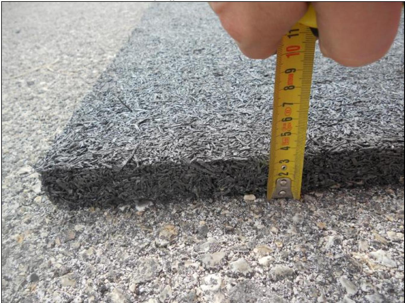
Ref: Elastypark Fino. Revestimiento sintético continuo negro (1000\*1000\*30) mm ensayado sobre base de asfalto.
